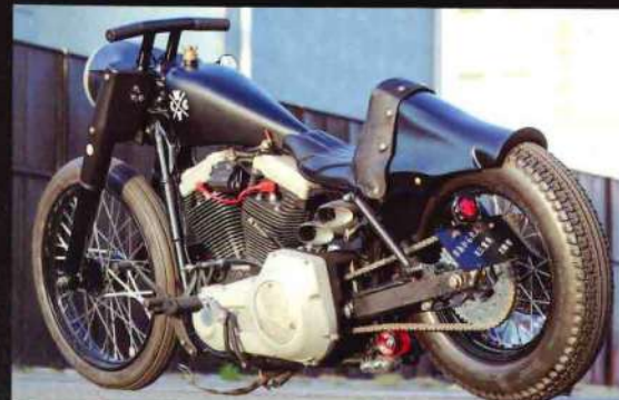
バッテリーをシートカウルに格納し、空いた空間からマフラーを左側へ出す。
