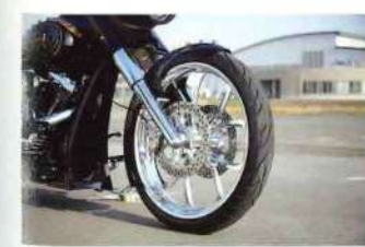
PMの23インチホイールを装着しながら、車高を低くするため、フォークを伸ばし、ネックを上げている
