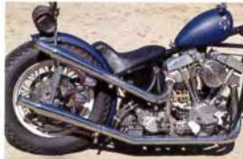
エキパイをワンオフしてアップスweepしたトランペットマフラー
