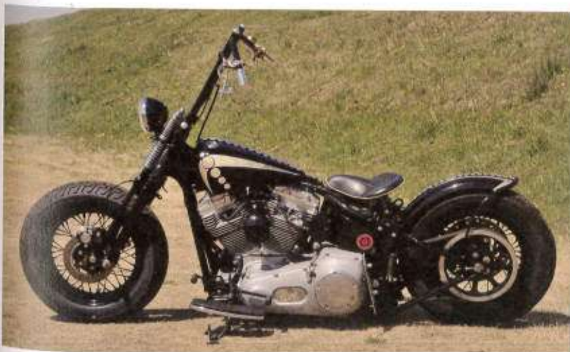
1 トライジャ岡本氏曰く、ナックル変身パーツのロッカーカバーとカムカバーはおそらくCC製。2 トライジャ製のストーンシート。3 ハンドルはラインダーバー。4 LEDテールライトを内蔵したリアフェンダー。5 フロントはもちろん74スプリンガー。ちなみにCVキャブは「Forty-Five Degree」でフルチューニング。
