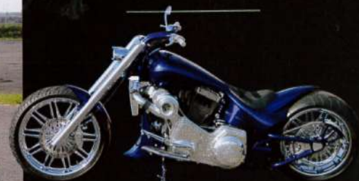
'03年式FLSTがベース。車高調整機能付きレジェンド製エアサス、ワンオフ製作の外装やパーツなど見所満載のフルカスタム
