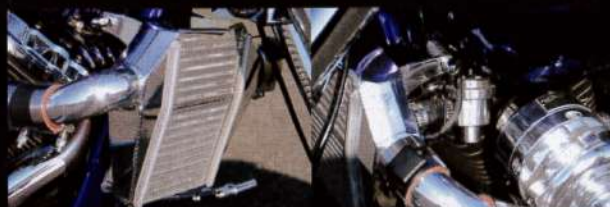
エアを冷却して吸入効率を向上させるインタークーラー。その造形や配管はすべてデザインに合わせてモディファイ
