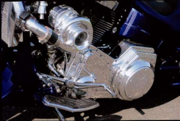
動力にプライマリーを利用するプロチャージャー。メーカーでは馬力とトルクが50~70パーセント向上すると謳っている
