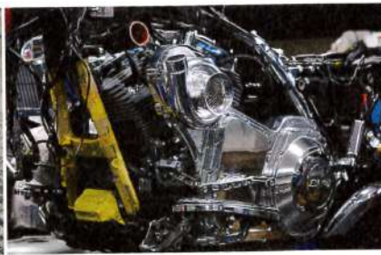
ファットボーイをベースに300のワイドタイヤを組み込んだフルカスタム。タイヤにあわせてエンジンとミッションの位置まで変更している
