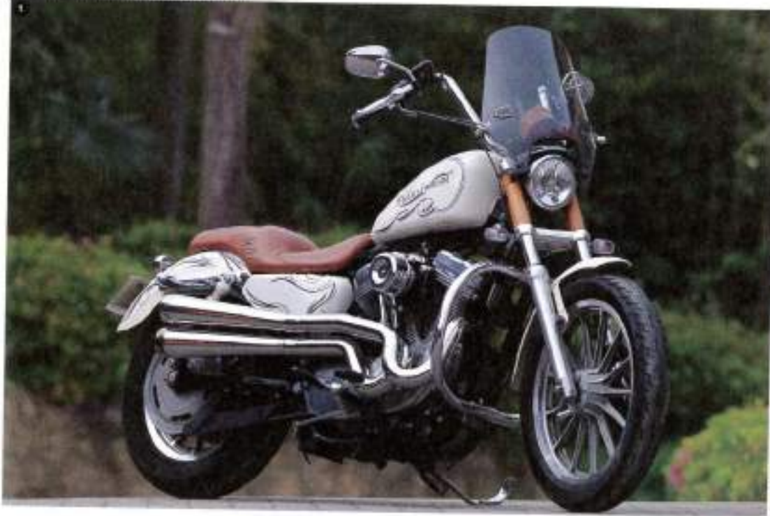
1: ノーマルのスポーティさをそのままに、シートやアップハンドル、シートなどで長時間でも疲労しにくいスタイリングがなされている。2: 白地にグレーとブルーでビンストライプを施しと選んだ。3: トライジヤのロゴをあしらったOVキャブトップカバーをセット。シンプルなおットロードエアライナーカバーを取り付けた。4: オーダーメイドの除けきシート。ポジションを前方にしてハンドルを近づけている。ビンストライプのような動きスナッチとサイドのスタックが美しい。5: マフラーには別業ライオン社製の「ダートトラックスタイルのハイパイプ」を装着
