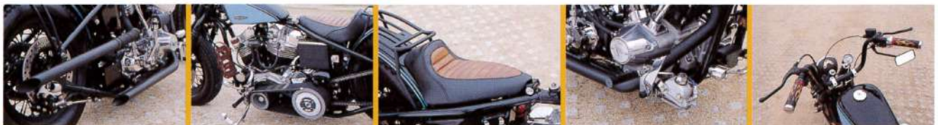
1: ハンドルはミディアム・エイブ・バーをセレクト。メーターまわりはキタコ製にリプレイス 2: ワンオフのマフラーを装着するために、オイル・フィルターを前方へ移設 3: 小ぶりだがクッション性の高いワンオフ・シート 4: プリモ製のオープン・プライマリーに交換 5: つや消しブラックに塗装したワンオフのドラッグ・タイプのエギゾースト
