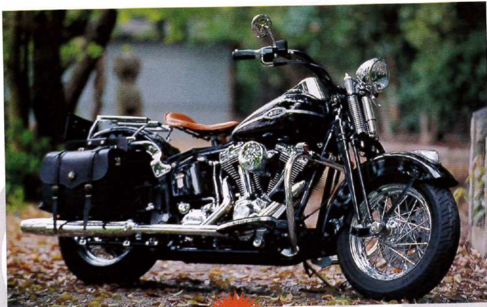
ライザーを介してハンドルの握りやすさを調整しないで、'48年式のFLと同形状のハンドルに交換してある
