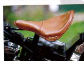
西部機材製のシート・ボスを使って、サドル・シートを装着。ココが換わると見え方も違う
