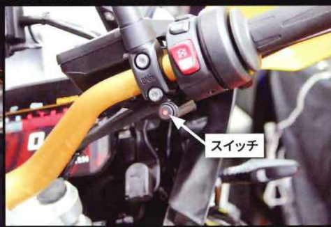
上の写真の右が全開状態で左が全閉状態。その中間状態もあり、操作はハンドルに装着されたスイッチひとつ(右下写真)で。左下のカットモデルを見ればわかるが、開閉バルブよりエンジン側にもバンキングメッシュが施してあり、この構造こそがジキル&ハイドマフラーの秘密らしい。価格は形状や対応車種によって変わるため、問い合わせください、とのこと。
