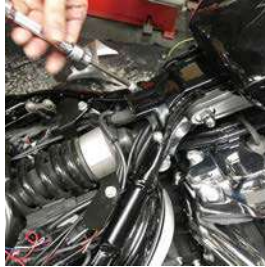
シートを取り外します。シートステーのボルトを取り外します。
