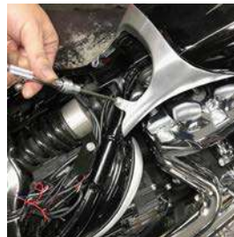
シートステーとストレッチカバーのボルト位置を合わせ取り外したボルトを締め直します。
