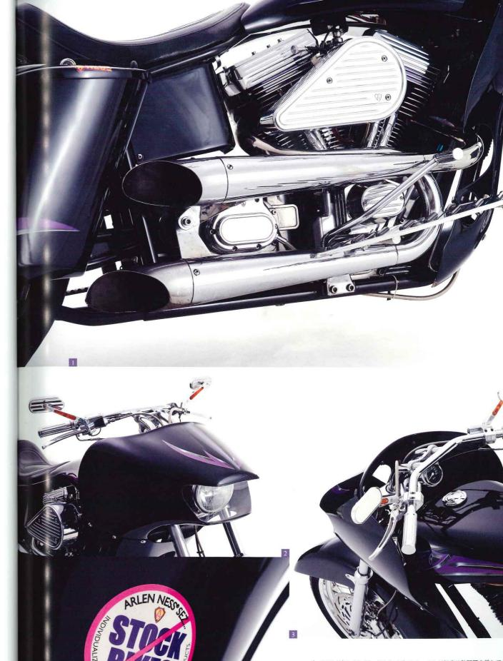
1\_フロントをハイライナーにしたメガフォン。エンド部分は熱問題を兼ねてターンナウトに。2\_トリブルツリーにマウントされたヘッドライドがカウル内で動く様には愛嬌を感じる。3\_スタイリッシュなアルミ製ストレッチタンクとハンドルバー。ネスらしいスタイルだ。4\_ "No Stock Bikes" のステッカーは、90年代半ば頃にネスのバイクではお馴染みだった。アレン・ネスのカスタムに抱く反骨の精神性が強く示されている。
