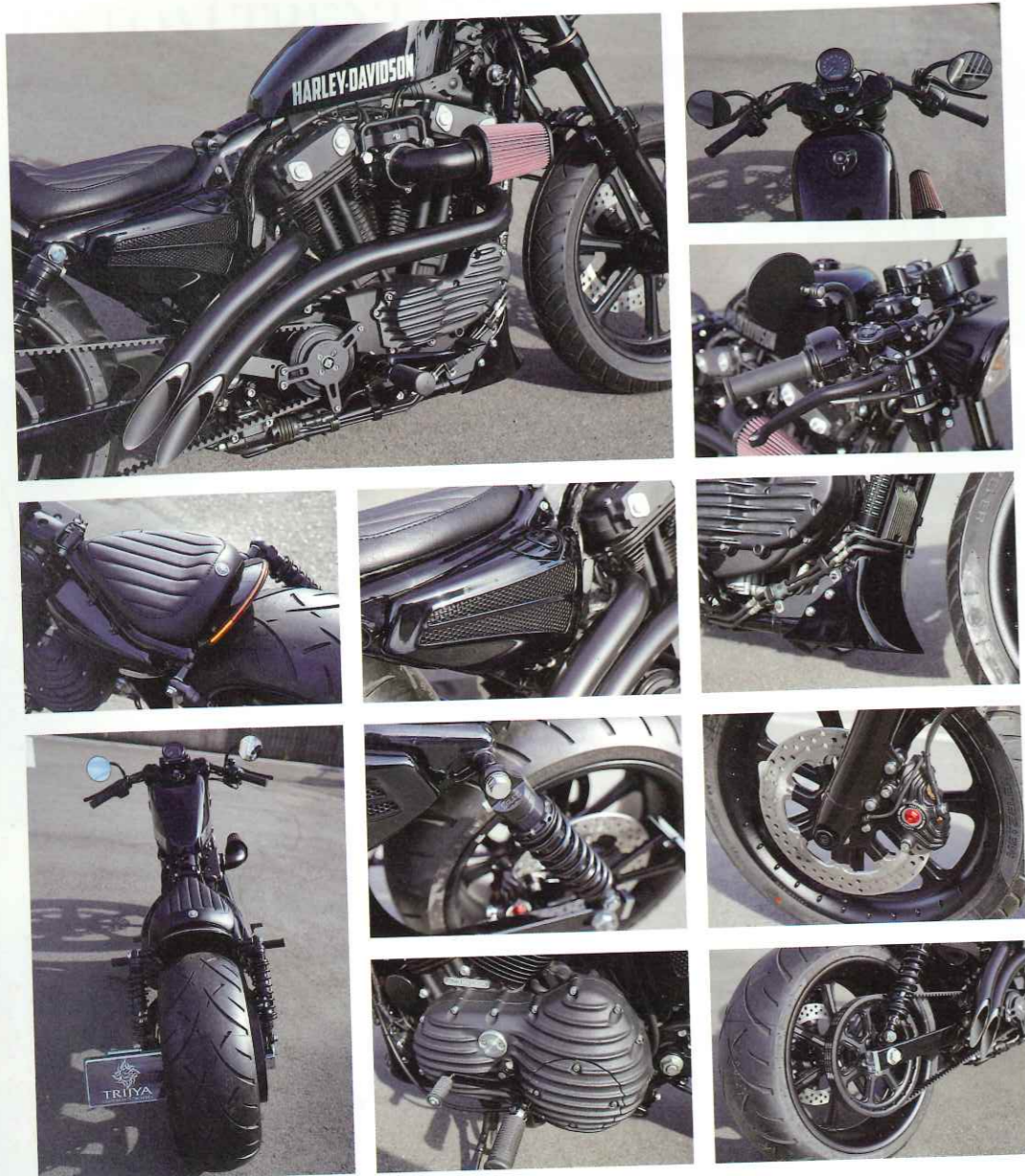
EMD製のロッカーカバーやカムカバーを装着し、趣を変えたスポーツスター・エンジン。マフラーはバンス&ハインズのヘルベントタイプ、エアクリナーは純正オプションのハイフロータイプに換装され、吸排気チューンが施されている。またハンドルバーはH-Dオプションのセパレートタイプとし、スイッチ類もRSD製に交換。車体前部に取り付けられたチンスポイラー、メッシュが施されたオイルタンク、LED灯火類が埋め込み式となったリアフェンダーやシートはトライジャ製ワンオフ。この違和感のない完成度はさすがである。ホイール及びブレーキキャリパー、ローター、リアサスなど走行性に関わるパーツはすべてRSD製。このマシン最大の特徴である240サイズの太さを誇るタイヤも印象的だ。プライマリもエンジン周りと同じくEMD製を装着する。
