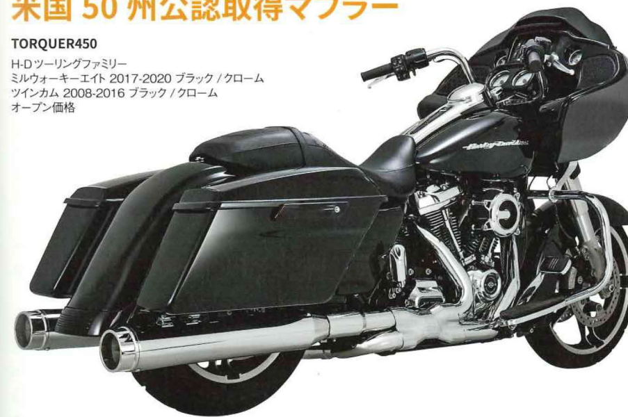
ツーリングファミリーにフィットする新型スリップオンマフラー「TORQUER450」。ベストサウンドとパワーを引き出すために開発・設計された内蔵パッフルは特許出願中。マフラーの仕上がりは、クロームとブラックの2種類が選べる。
