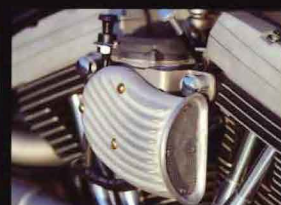
CVキャブはダイノジェット入り。エアクリナーはスローバックサイクルパーツ。
