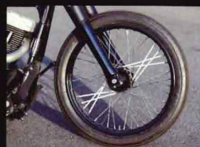
フロントホイールのダブルフランジハブをスプールハブのように削っている。
