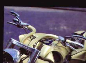
SJP製フォークにワンオフ製作したライザーバー、HHI製ミラーを装着した。
