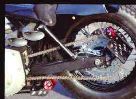
パウコのリジッドバーを短くしてローダウン。チェーンテンショナーを備える。
