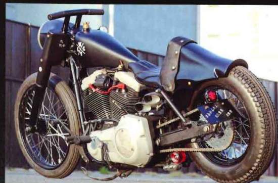
バッテリーをシートカウルに格納し、空いた空間からマフラーを左側へ出す。
