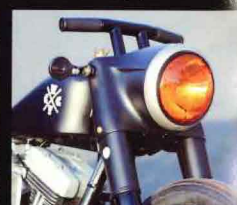
ブラックのフロントフォーク、マトブラックのヘッドライトナセルはバンヘッドのものを使用する。
