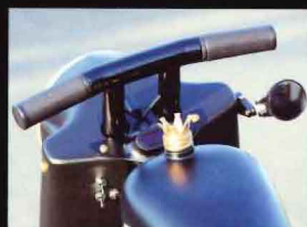
ワンオフハンドルはナセルに合わせた幅に。メーターはモトジェット製。
