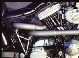
バッテリーをシートカウルに格納し、空いた空間からマフラーを左側へ出す。
