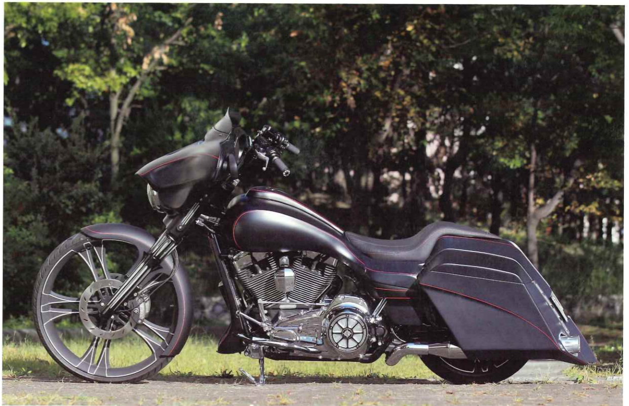
2015年式FLHXをベースに、足回りを前26”、後18”のサンダーバイク製ホイールへと変更。ハイテクなイメージで仕上げている。
