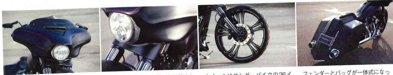
ラッシュモア以降のダクト付きカウルをアレンジして製作されたトライジャのオリジナルカウル
