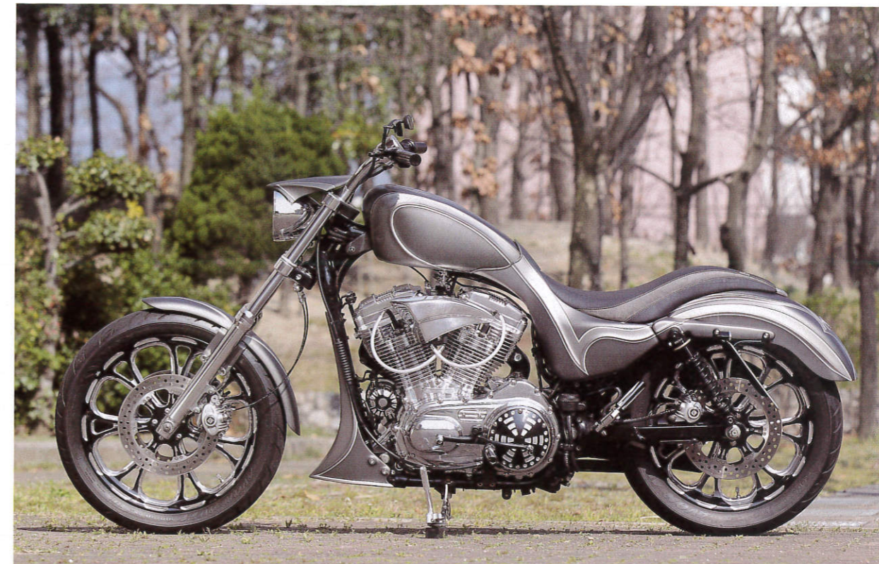
外装は純正部品を元にして、板金加工とペイントのみでその造形と質感を高めている。高いスキル故の優れたアレンジメントだ。
