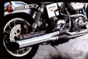
マフラーはエキパイを製作しエンドはショベル純正を使う。5速ミッションにはショベルのキックアップを。セルモーターも強力なものに
