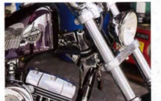
小ぶりだけど長距離も安心なキングスポーツスタータンクを装着。フレームを整えているから、小さなタンクをハイマウントにできるのだ
