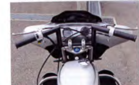
今のバグースタイルに合うように、メーター埋め込み加工をしている
