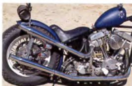
エキパイをワンオフしてアップスイープしたトランペットマフラー
