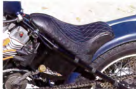
リジット化したフレームとリアフェンダーに合わせたワンオフシート
