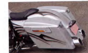
バグーキットはモンキーダビッドソン用を加工して取付
