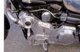
クランクから出力を取り出すスーパーチャージャー搭載!!
