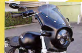
ヘッドライトを覆う小ぶりなカウルによって、高速時に走行風を軽減
