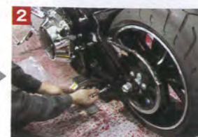
2 純正ベルトガードのトップとアンダー、その二つを取り外せば、基本的に作業自体は60%終了。あとはVSR ナンバーサイドマウントを用意すればよいは準備完了です。
