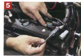
5 カスタムの仕様によって配線の処理が変わる為、一概には言えないが、元のナンバー照射灯のカプラーにギボシ等を使い、配線を繋げばOK。理屈を考えれば簡単だ。
