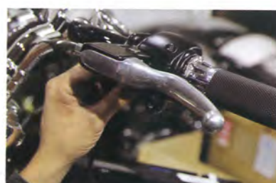
今回はご覧のスイッチボックス下に刻美ウインカーを取り付けることに。このようにどこでも貼れるのがテープ式の利点だろう。平面箇所なら自在に配置可能だ。
