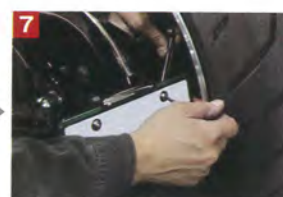
7 配線を繋いだら、あとはナンバープレートを付けるだけ。このキットならリム側ギリギリ追い込んでナンバーを取り付けることも可能。ちなみに縦横調整は自由自在です。
