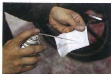
粘着テープを使用して取り付けるからには、まずはホコリと油分を落とすことを忘れないようにするのも基本。装着箇所は予めパーツクリーナーで軽く洗浄したい。
