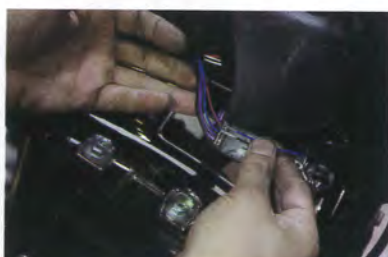
ご覧のような青なら青、紫なら紫と同色の配線に繋ぐのも作業の基本中の基本。無論、取り付けの際は圧着ペンチやギボシ端子、カプラーを使い配線を処理したい。
