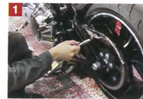
1 FXCW(ロッカー)とFXSB(ブレイクアウトスタンダード)、FXSBSE(ブレイクアウトCVO)に適合するこのナンバーですが1/2レンチでベルトガードを取り外す。
