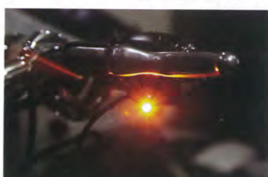
ハンドルスイッチBOX下に収まるコンパクトなサイズながら、びかっと光ればご覧のとおり存在感。抵抗を新たに追加する必要がない部分も刻美の利点だ。
