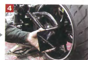
4 このVRサイドプレートはご覧のとおり、ナンバー照射用のLEDが付属。こうした部分で道交法に準じた仕様となっているのもユーザーにとっては嬉しい限りだろう。
