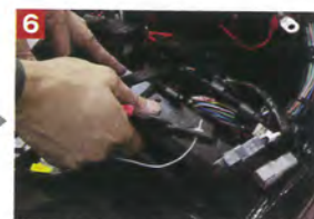
6 配線の皮を向き、ギボシを取り付ける際はご覧のような圧着ペンチ等の電工工具を忘れず、配線をねじって繋ぎ、テープで巻くなどの手抜き作業はトラブルの元。だ。
