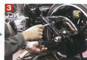
3 ご覧のようにソフトテイル系モデルに完全ボルトオンゆえ、取り付け自体はベルトガードを外し、その穴位置にVSR ナンバーサイドマウントを取り付ければ基本、完成。
