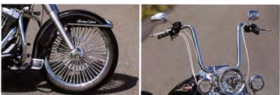
前後のホイールはビッグダディ製のシニスターでフロントは21インチ、リアは16インチにセット。17インチのエイブハンガーでスタイルを体現しつつ操縦性も考えている。LEDのバッシングライトも取り付けている
