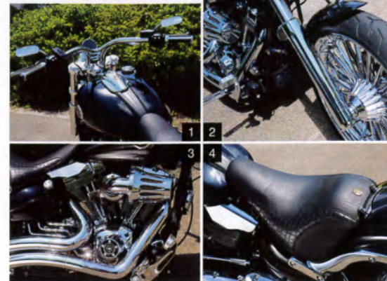
1:ハンドルとミラーはアレンネス製。2:フォークはダイナ用でグッツ製コンバージョンアクスルシャフトを使用する。ヘッドライトは純正P&Aで純正LEDライトを内蔵。3:エンジンはスクリーミンイーグル製スーパーチューナーでチューニング済み。4:シートはトライジャ製で高級感を演出する
