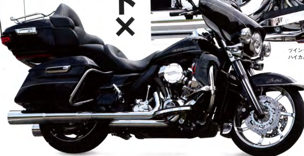
世界的にも例のないツインクルドTCエンジンへのスーパーチャージャー装着。ストックの排気量ながら、エンジンカスタム+EFIチューニングを加えて150馬力をマークしている
