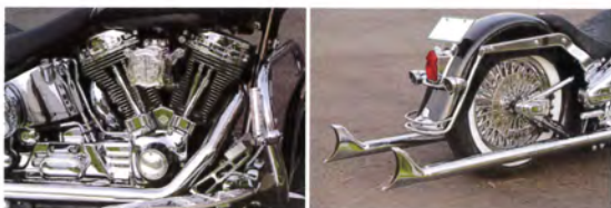
エンジンはバンヘッド風ロッカーカバーと45ディグリーのフルチューンCVキャブをセット。刻美ミニクリナーはフィルターの外周に飾り板をワンオフで製作。2本出しのマフラーはサムソン製ロングフィッシュテールだ
