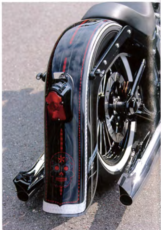
エキゾーストシステムはケステック製ESMを2本だしてセット。リアフェンダーを6インチ延長しテールライトはツームストーンを選択。エアブラシはマーセル・シンウェルの手によるもの。リアホイールは18インチでリム幅4インチ。エアサスを使ってローダウンしている
