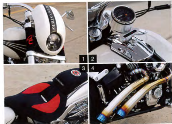
1:ショップオリジナル、ウインドブレイクシールドは顔付を一変させる 2:メーター移設キットもオリジナルで作られている。ブレイクアウトオーナー必見! 3:座り心地とホールド感を兼ね備えたシート 4:フルチタンで作られたエキゾーストもオリジナル。焼け具合までもがデザインになる
