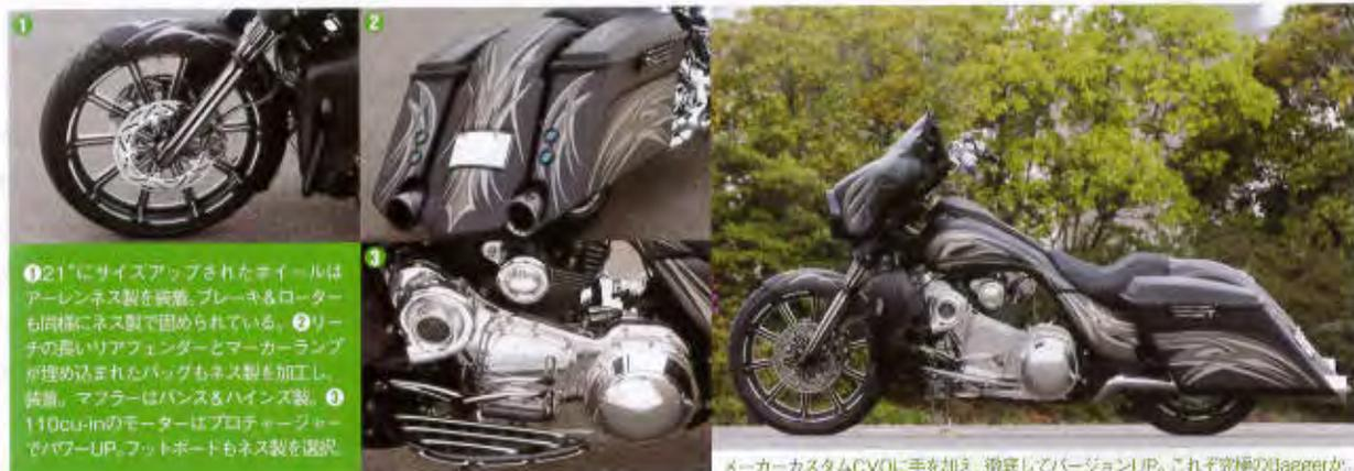
①21"にサイズアップされたホイールはアーレンス製を装着。ブレーキもローターも同様にネス製で固められている。②リーチの長いリアフェンダーとメーカーランプが埋め込まれたバッグもネス製を加工し、装着。マフラーはバンス&ハインズ製。③110cu-inのモーターはプロチャージャーでパワーUP。フットボードもネス製を選択。
