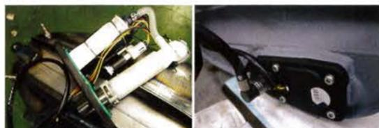
スポーツスター純正のフューエルポンプを、他のガスタンクやワンオフのガスタンクに取り付けるには、ポンプが純正と同じようにマウントできるようにタンク側の接地面を加工する必要がある。取り付け位置や角度なども考慮する点も多い
