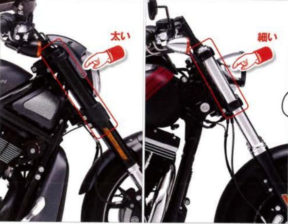
倒立はインナーとアウターチューブの位置関係が正立と逆なので、より太いチューブをステムにクランプすることができる。そのためフロント周りの剛性面で有利になる
