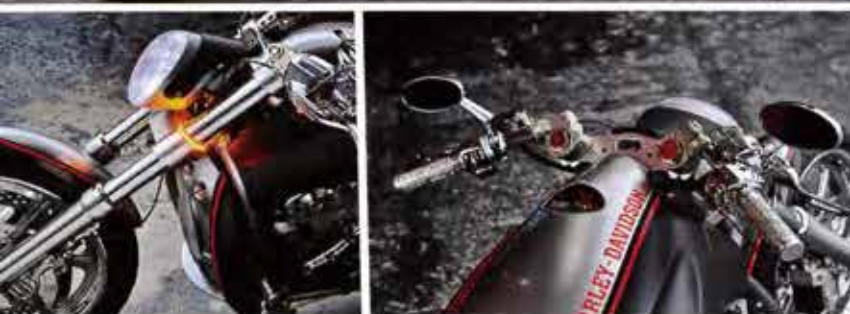
用一体型タンクシートをベースとし、徹底的に手を加えて生み出されたシンプルなボディが、アルミスイングアームで300ホイールをマウント、リアサスはオーリンズ。ターンアウイブがユニークなマッチング。ライン上に配置したフレキシブルなLEDを使用したストップはスマートなアイデアだ。
