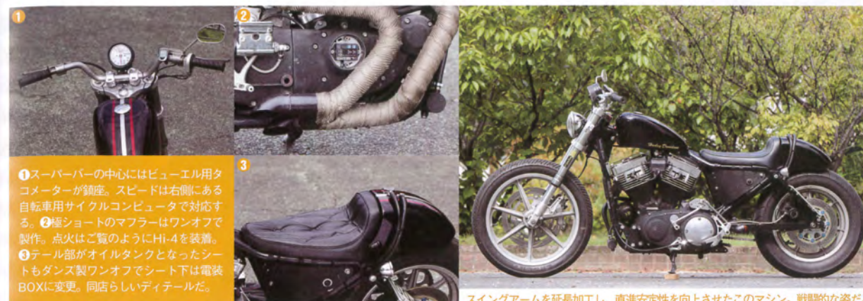
スイングアームを延長加工し、直進安定性を向上させたこのマシン。戦艦的な姿だ。
