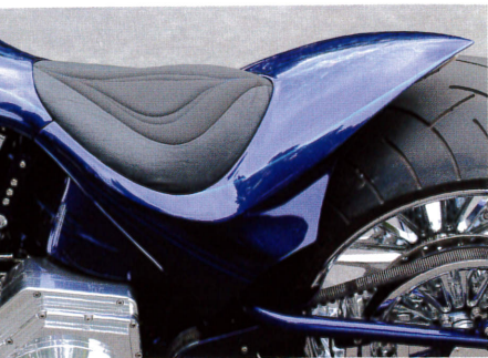
「外装はすべてワンオフ。タイヤから上に向かって台形に広がっていくフェンダーがポイント。サイドのカーブがスイングアームの幅広感を和らげている」
