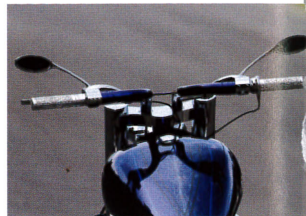
「油圧クラッチのマスターを含めたコントロール類はOMP。グリップは刻美。タンク前方にはモトガジェット、メーターが埋め込まれ、ハンドルとタンクの隙間を埋めるデザインになっている」
