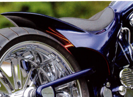
「アサスでリアが持ち上がると反射で魅せるテールライト顔をのぞかせる。トライジャオリジナルの高輝度LEDなので視認性は十分。サイドのふくらみにはウインカーが潜む」
