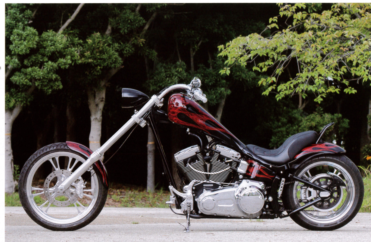
ストックのソフトテイル・シャシーをベースに、ステムをエクステンド。リアエンドも260サイズに合わせてワイド化されている。
