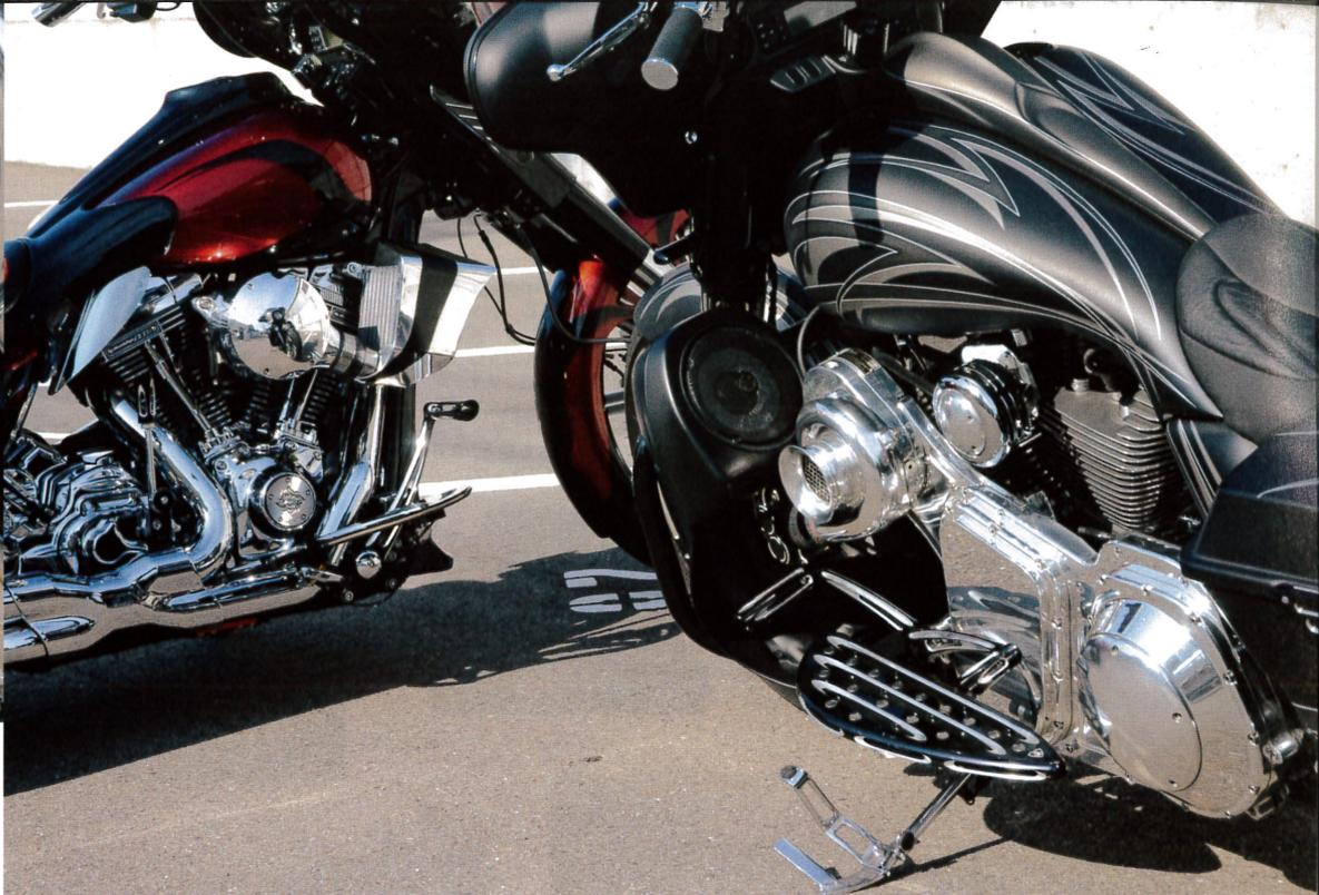
ハーレーのエンジンをよりパワフルなものにするものひとつに過給機がある。つまりスーパーチャージャーやターボチャージャーといった装置で、通常エアクリナーから吸いこむ空気をファンなどを使って強制的に取り込むものだ。
