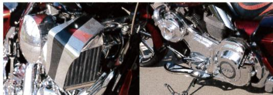
写真左のインタークーラーは取りこんだ空気を冷やし、圧縮するための装置。ノーマルのままでは溶接痕が目立つため、トライジャで加工し、車体のスタイリングにマッチさせている。圧縮された空気はスロットルボディを経由して、大量の混合気となりエンジン内へ
