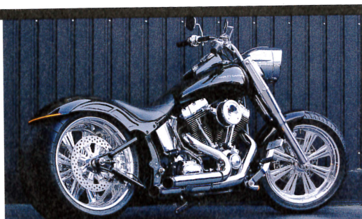
ファットボーイをベースに300のワイドタイヤを組み込んだフルカスタム。タイヤにあわせてエンジンとミッションの位置まで変更している
