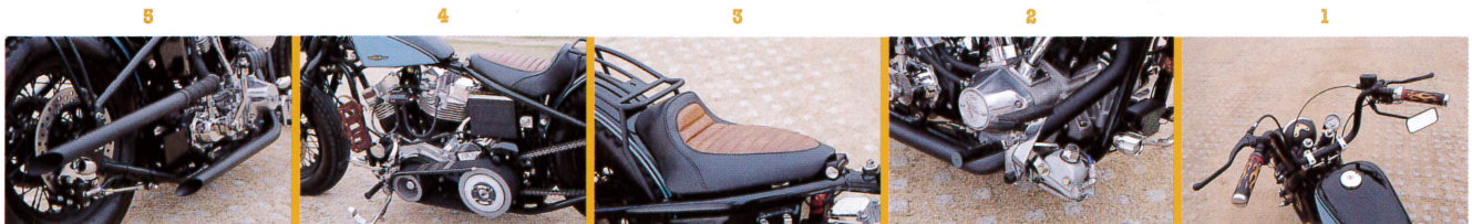
1: ハンドルはメディアム・エイブ・バーをセレクト。メーターまわりはキタコ製にリプレイス 2: ワンオフのマフラーを装着するために、オイル・フィルターを前方へ移設 3: 小ぶりだがクッション性の高いワンオフ・シート 4: プリモ製のオープン・プライマリーに交換 5: つや消しブラックに塗装したワンオフのドラッグ・タイプのエグゾースト
